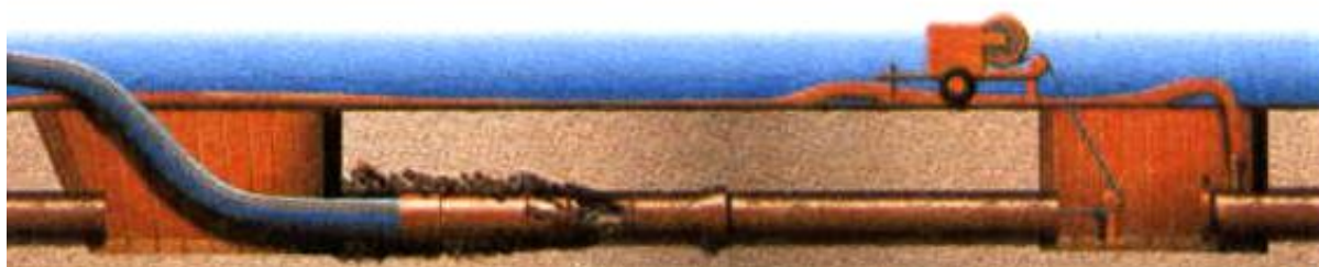
انهدام لوله قدیمی و جایگذاری آن با فشار ثابت
