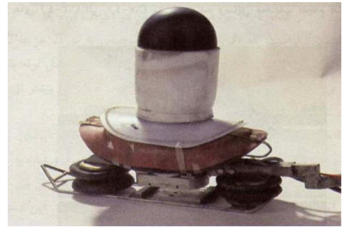
دستگاه بازگشایی انشعاب در لوله
